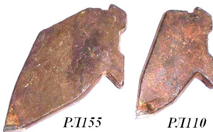
Рисунок 2.40 – Резцы для строговых установок фирмы «ДВТ»
