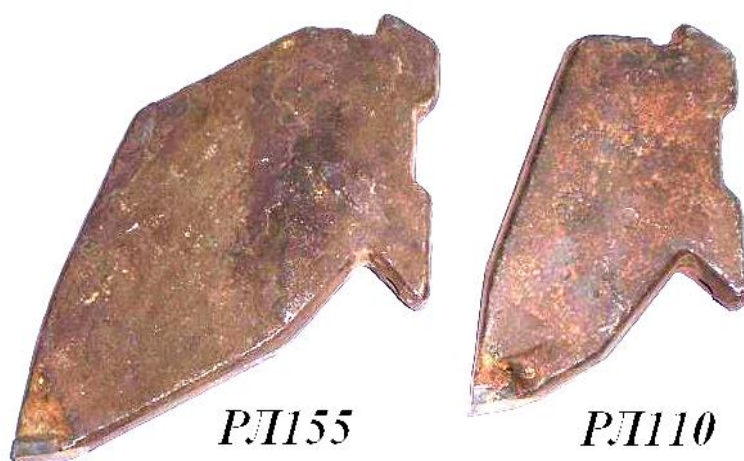
Рис. 2.30. Немецкие резцы для струговых установок
