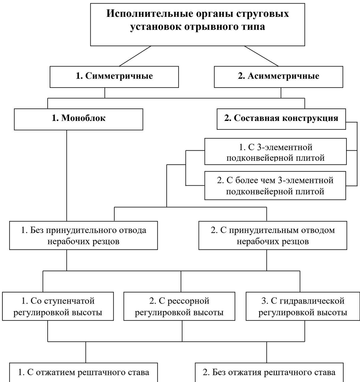
Рис. 2.10. Классификация исполнительных органов струговых установок отрывного типа
