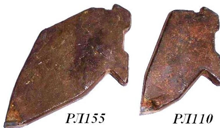
Рис. 2.13. Резцы для струговых установок фирмы «ДВТ»
