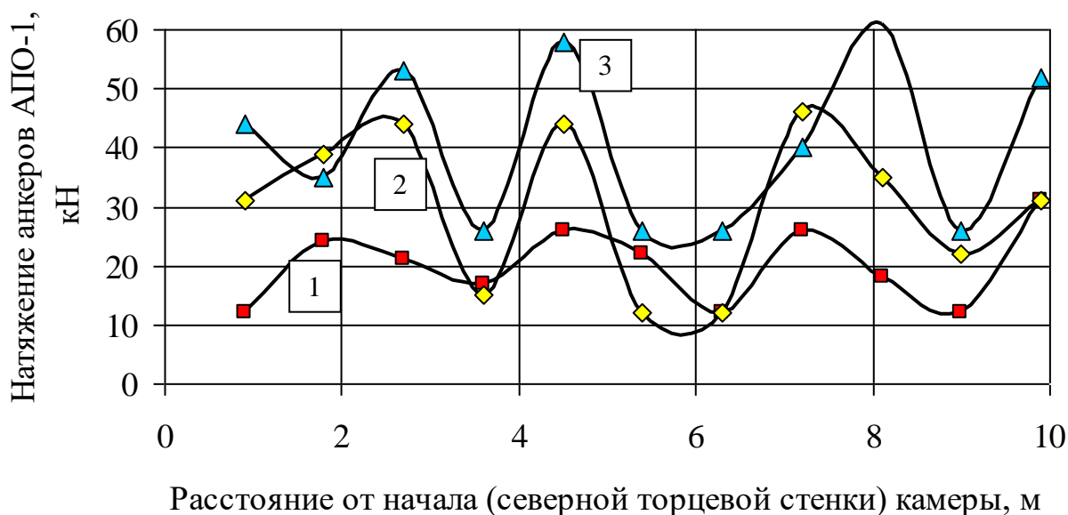
Рис. 6.48. Натяжение анкеров АПО-1 продольного ряда, расположенного посередине пролёта камеры привода конвейера 1Л120У конвейерного ходка уклона № 3 шахты «Обуховская»: 1 – предварительное (начальное); 2 – в период сооружения камеры(0,2 г.); 3 – по истечению 1 г. поддержания камеры
