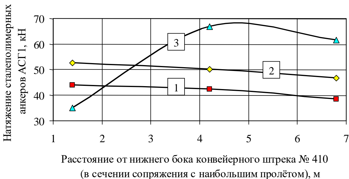
Рис. 6.34. Натяжение сталеполимерных анкеров АСГ1:
