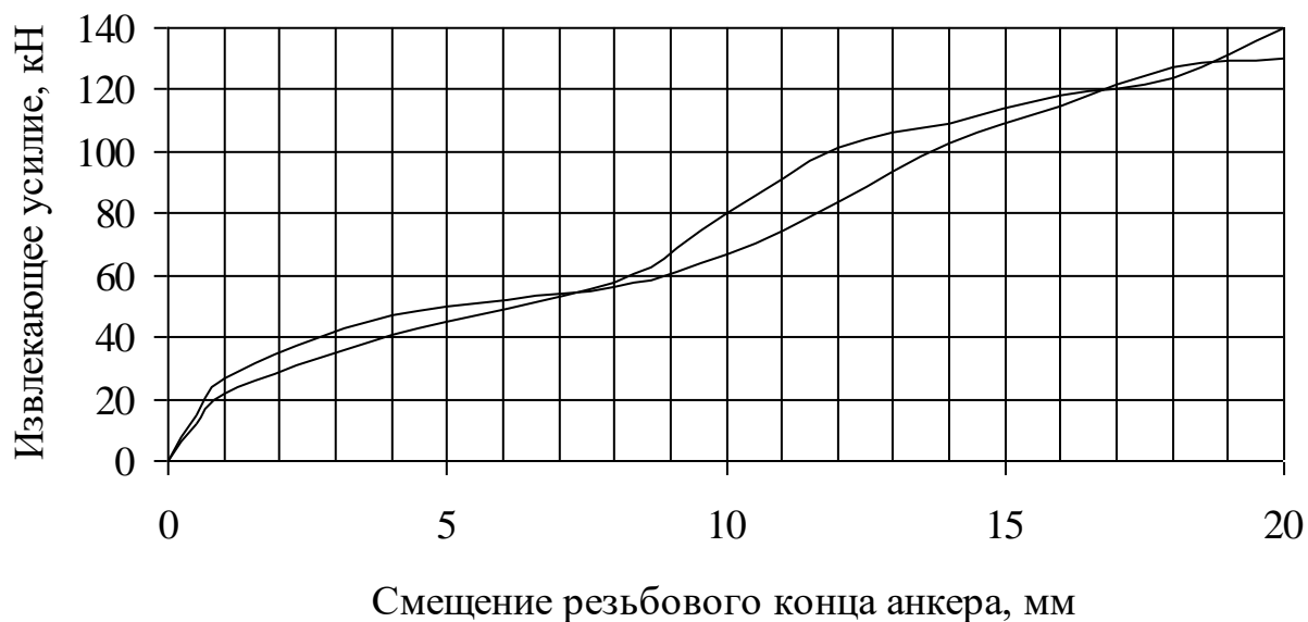
Рис. 6.47. Деформационно-силовая характеристика анкеров АПО-1, установленных в продольные ряды
