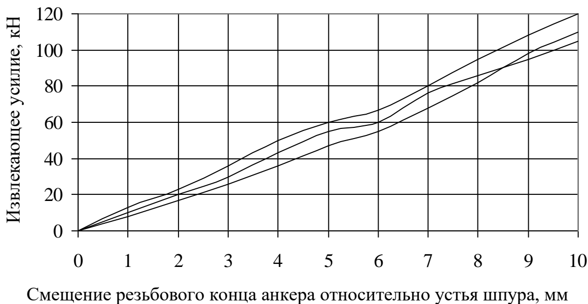
Рис. 6.31. Деформационно-силовая характеристика сталеполимерных анкеров АСГ1 с типоразмером резьбы м 20 на концах
