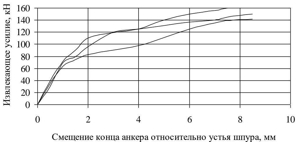
Рисунок 2 – Деформационно-силовая характеристика анкеров АСГ-1, установленных в кровлю камеры привода ленточного конвейера 2Л100У конвейерного хода бремсберга № 02 шахты «Ростовская» ОАО «Алмазная»
