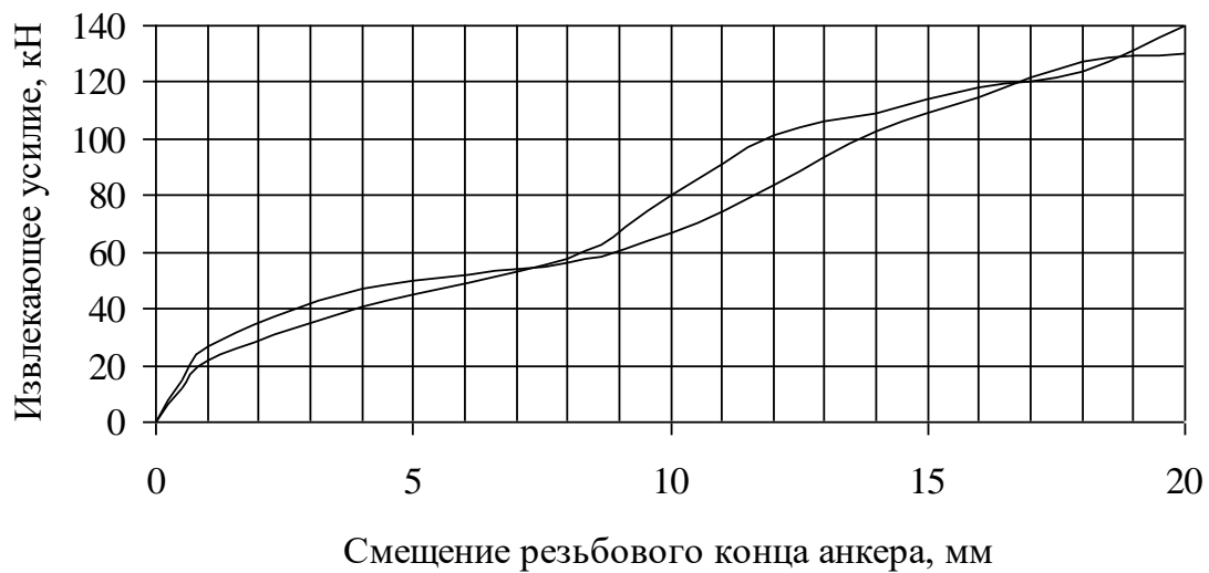
Рисунок 7 – Деформационно-силовая характеристика анкеров АПО-1 , установленных в продольные ряды в кровлю камеры привода конвейера 1Л120У конвейерного ходка уклона № 3 шахты «Обуховская» ОАО «Шахтоуправление «Обуховская»
