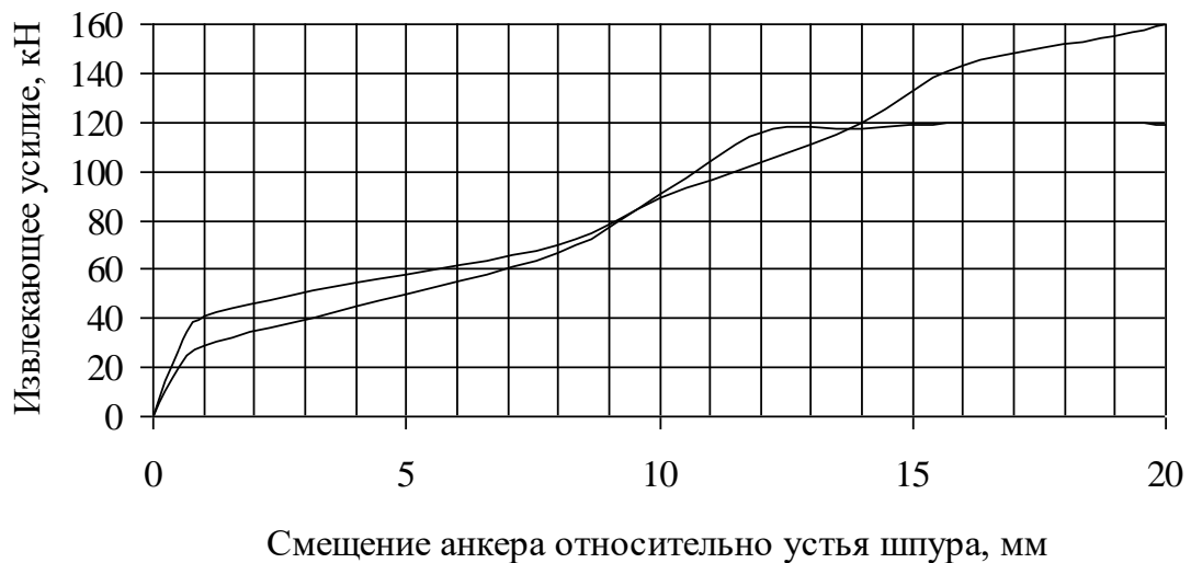
Рисунок 6 – Деформационно-силовая характеристика анкеров А20В , установленных в поперечные ряды в камере привода конвейера 1Л120У конвейерного ходка уклона № 3 шахты «Обуховская» ОАО «Шахтоуправление «Обуховская»
